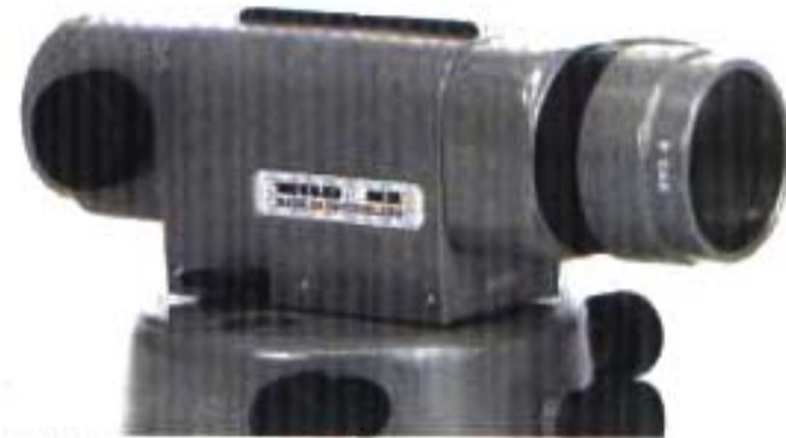
Wild NK2 con lente adicional GVO para punterías cortas
