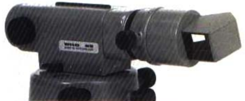
Wild N2 (NK2) con Prisma-objetivo giratorio para punterías verticales
